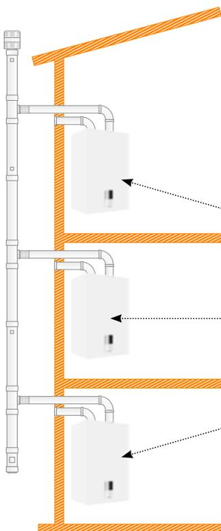
**S.P.H.:** Sistema de Protección de Humos. La válvula antirretorno de humos (instalada de serie) permite una **fácil conexión a sistemas colectivos de humos a presión**. Para los instaladores la solución del conducto colectivo a presión **es más económica** (reducción de los diámetros de las chimeneas).
